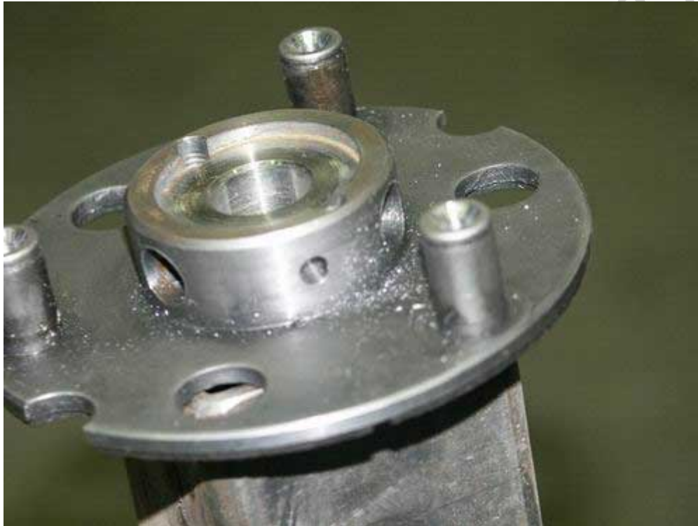
Aangepaste grondplaat met de tapgaatje in de asjes voor de bevestiging van de ring.
